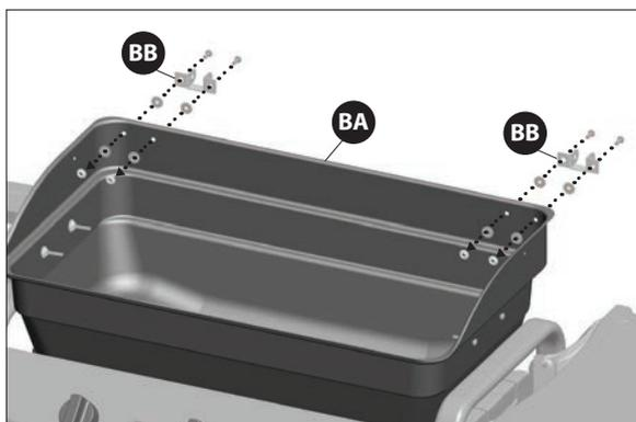
Fixez la charnière inférieure (BB) à l'arrière de l'assemblage du boîtier à brûleur (BA), tel qu'illustré.
