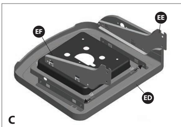
c. Assemblez les supports de la tablette latérale avant et les supports de la tablette latérale arrière (EE & EF) à la table du brûleur latéral gauche (ED) à l'aide de deux vis, comme le montre la figure C.
