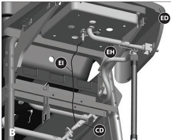
d. Attachez le bout du fil d'électrode pour brûleur latérale (EI) à l'allumeur (CD) tel qu'indiqué à la figure B. Assurez que le fil est bien fermement entré.
