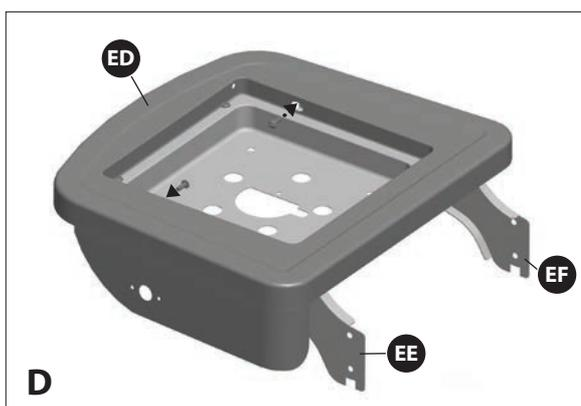
d. Tournez la table du brûleur latéral gauche (ED) et utiliser deux vis pour terminer l'assemblage des supports de la tablette latérale avant et les supports de la tablette latérale arrière (EE & EF), comme le montre la figure D.
