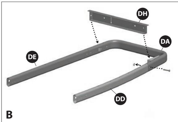
Fixez l'entretoise de côté (DH) à la patte de chariot avant gauche (DD) en utilisant la quincaillerie, comme illustré sur le schéma B.
