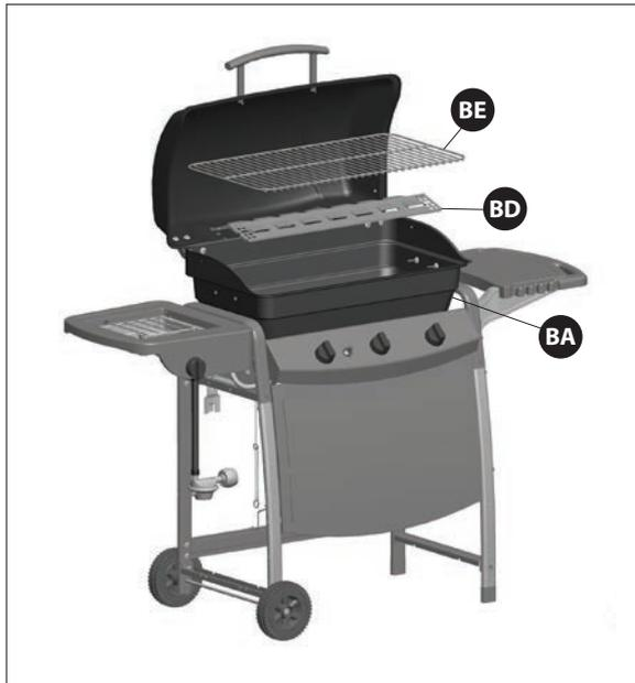
Positionnez le couvre-flammes (BD) dans l'assemblage du boîtier à brûleur (BA).
