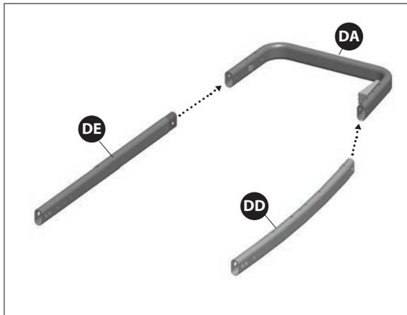
Insérez les pattes du chariot gauche (DD & DE) dans la barre de soutien de jambe supérieure (DA), comme indiqué.
