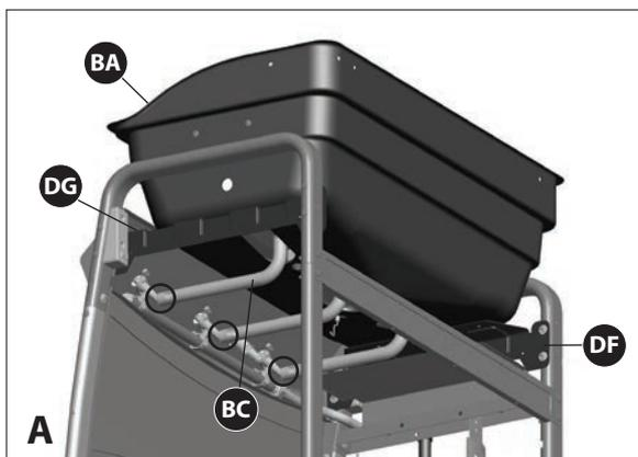
c. Positionnez l'assemblage du boîtier du brûleur (BA) sur les supports du boîtier du brûleur (DF & DG), tel qu'illustré sur le schéma A.
