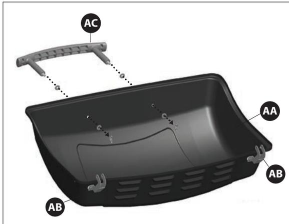
a. Fixez la poignée du couvercle supérieur (AC) sur l'assemblage du couvercle supérieur (AA).
