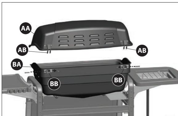
Pour fixer l'assemblage du couvercle supérieur (AA) à l'assemblage du boîtier à brûleur (BA), positionnez les charnières supérieures (AB) entre les charnières inférieures (BB), positionnez les pièces de fixation et fixez le tout au moyen des goupilles d'attelage (n° 17).
