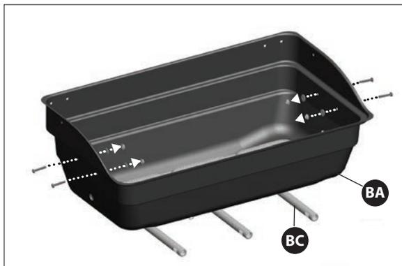
a. Assemblez le brûleur (BC) dans l'assemblage du boîtier à brûleur (BA), les tubes venturi du brûleur orientés vers l'avant.
