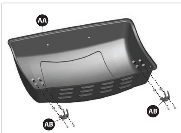
Fixez la charnière supérieure (AB) à l'assemblage du couvercle supérieur (AA).
