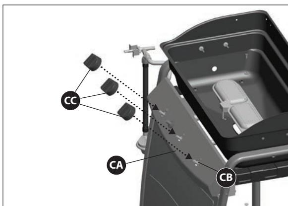
e. Mettez les boutons de réglage (CC) sur les tiges de manœuvre (CB).
