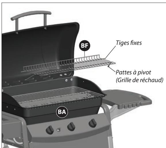
Pour assembler les grilles de chauffage (BF), insérez le fil fixe dans les ouvertures pratiquées sur les parois latérales du couvercle. Insérez les pieds de pivotement de la grille de chauffage (BF) dans les ouvertures situées à l'intérieur de l'assemblage du boîtier à brûleur (BA), tel qu'illustré.
