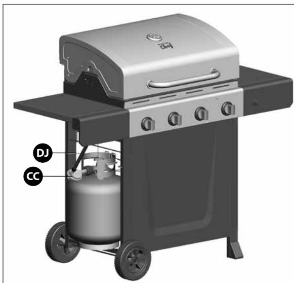
Placez le fond de la bonbonne de GPL dans les encoches situées sur le bas du panneau latéral gauche du chariot (DB). Positionnez le support pour réservoir de gaz (DJ) sur la collerette du réservoir. Attachez l'écrou de serrage du régulateur (CC) à la valve de la bonbonne de GPL.
