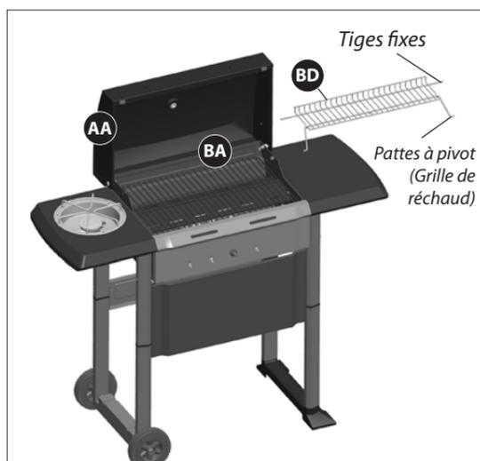
Pour assembler les grilles de chauffage (BD), insérez le fil fixe dans les ouvertures pratiquées sur les parois latérales du couvercle (AA). Insérez les pieds de pivotement de la grille de chauffage dans les ouvertures situées à l'intérieur de l'assemblage du boîtier à brûleur (BA), tel qu'illustré.
