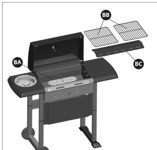
a. Positionnez le couvre-flammes (BC) dans l'assemblage du boîtier à brûleur (BA).
