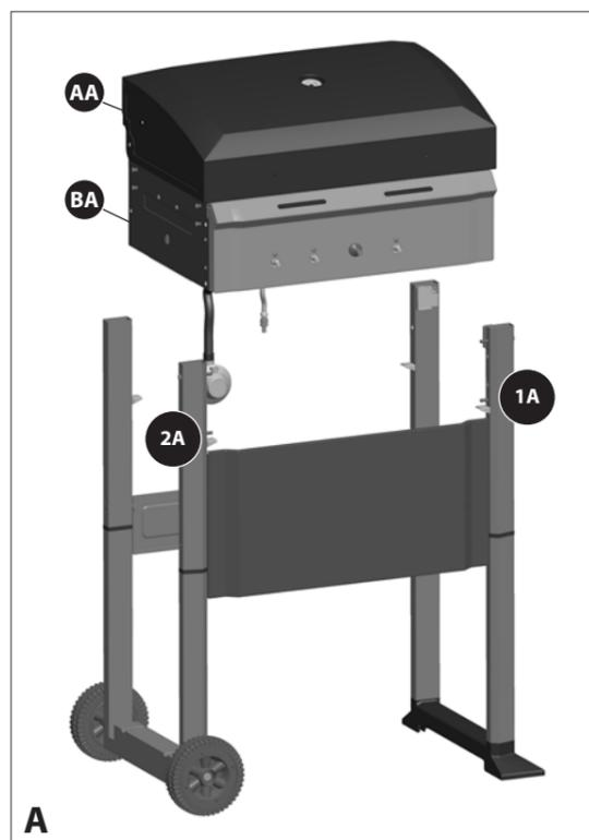
Positionnez et assemblez l'assemblage du couvercle supérieure (AA) et compartiment des brûleurs (BA) aux pattes de chariot 1A et 2A. (Figure A et B)
