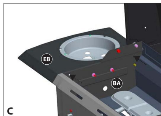
a. Installez la tablette latérale gauche (EB) sur les vis pré assemblé au compartiment des brûleurs (BA).
