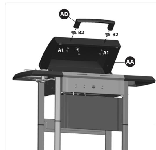
Fixez la poignée du couvercle supérieur (AD) sur l'assemblage du couvercle supérieur (AA).
