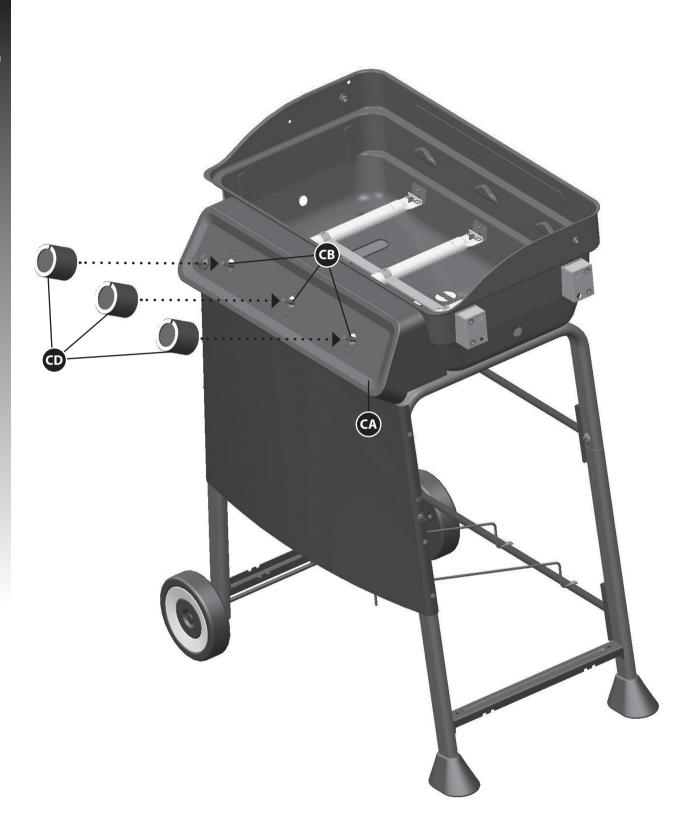
TIGHTEN SCREW HALFWAY, AS SHOWN
