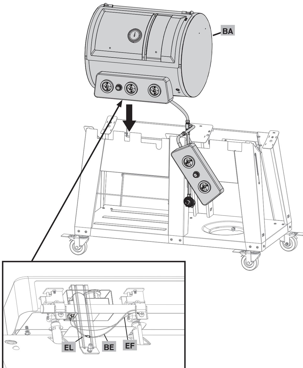
\* Vérifiez si l'ensemble d'électrodes du brûleur (BE) côté barbecue est assemblé fermement au fil de connexion électronique du fil d'allumage (EL).
