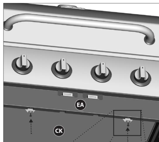
Assemblez l'écran thermique (CK) au bas du Rail de support pour la porte (EA) et le panneau arrière supérieur (BH), comme illustré sur le schéma A et B.
