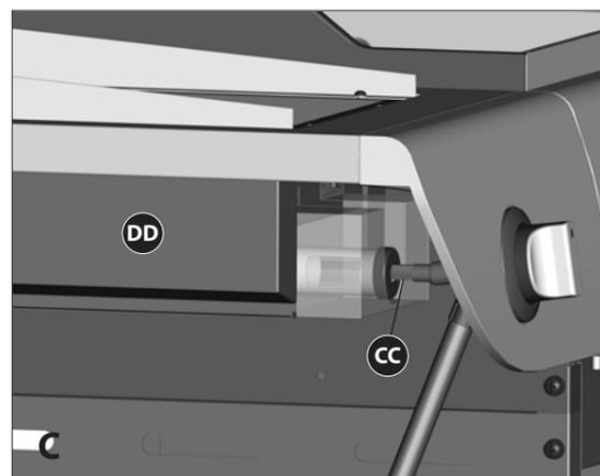
c. Assurez-vous que le brûleur (DD) engage la valve du brûleur (CC) et le bec de gaz, comme indiqué sur le schéma C.
