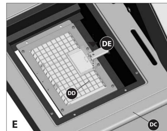
e. Faites passer le fil de l'électrode du brûleur Infrarouge (DE) en dessous du brûleur Infrarouge (DD) à travers la petite ouverture sur le côté droit de l'encadrement de soutien (DC). Alignée et montez l'électrode à l'aide de la vis auto taraudeuse fournie, tel qu'illustrée à la figure E.
