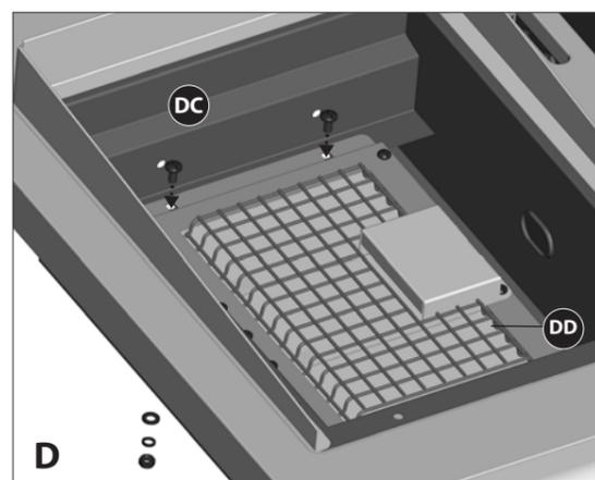
d. Assemblez le brûleur Infrarouge (DD) a l'encadrement de soutien brûleur Infrarouge (DC) au 2 points indiquer au schéma D.
