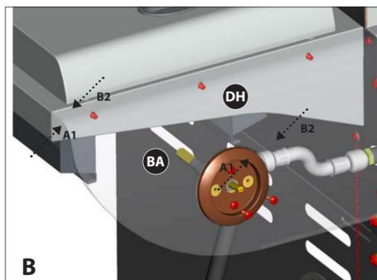
b. Assemblez la tablette droite (DH et DI) au panneau latéral supérieur du boîtier des brûleurs (BA) en positionnant la quincaillerie à travers l'intérieur du boîtier des brûleurs, comme illustré sur le schéma B.
