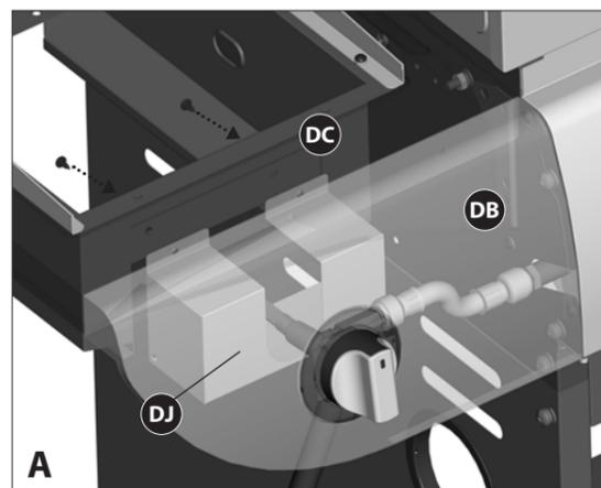
a. Fixez le para-vent du-brûleur latéral infrarouge (DJ) à la cuvette de propreté pour le brûleur latéral (DC).
