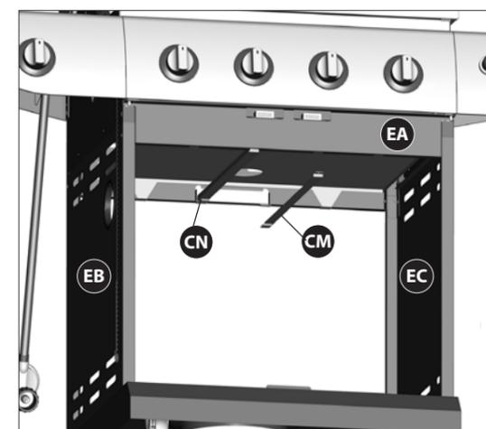
a. Assemblez les rails gauche et droit (CN and CM) pour le plateau à graisse (CL), comme illustré sur le schéma A.
