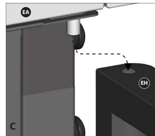
a. Assemblez l'ensemble de la porte droite (EH) à l'étagère inférieure (ED) en insérant la tige fixe (au bas de la porte) dans le trou fourni (schéma B).
