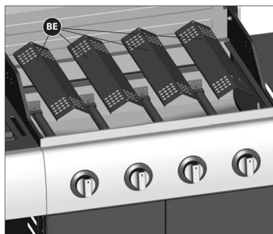
b. Positionnez d'abord les brise-flammes (BE) dans le compartiment des brûleurs.
