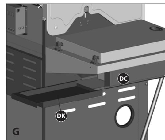
g. Insérez le plateau à graisse du brûleur infrarouge (DK) dedans le dessous de l'encadrement de support pour brûleur infrarouge(DA) tel qu'illustrée.
