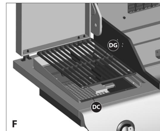
f. Positionnez la grille de cuisson (DG) sur l'encadrement de soutien brûleur à Infrarouge (DC).
