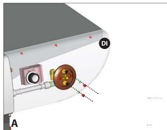
a. Retirez les ferrures pré assemblées du support de la valve de la rôtissoire (BN) tel qu'indiqué sur le schéma A.
