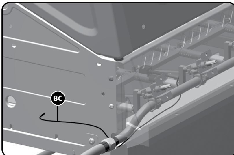
**Attention :** Alimentez le fil d'électrodes du brûleur principal (BC) à travers le trou sur le côté gauche des brûleurs.
