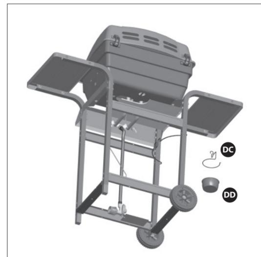
Suspendez le crochet du réservoir de graisse (DC) au bas du boîtier du brûleur (BA), tel qu'indiqué. Placez le réservoir de graisse (DD) sur le crochet (DC).
