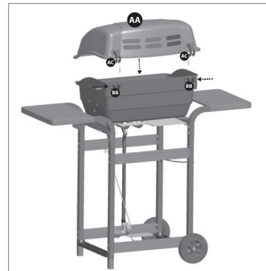
Pour monter le couvercle supérieur (AA) au boîtier du brûleur (BA), positionnez les charnières supérieures (AC) entre les charnières inférieures (BB), mettez les ferrures en place, puis verrouillez à l'aide des chevilles.
