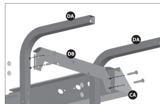
a. Assemblez le support arrière gauche du boîtier à brûleur (DB) et le support arrière droit du boîtier à brûleur
