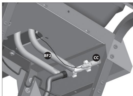
Raccordez le fil-électrode du brûleur (BF2) à l'allumeur (CC).
