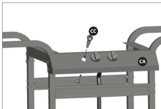
a. Faites passer la soupape (CD) par l'arrière du panneau de commande (CA) et procédez au montage.
