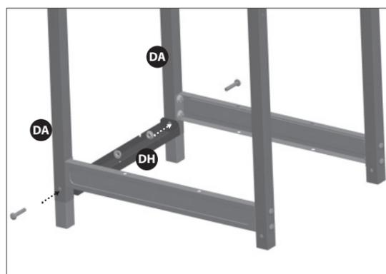
b. Fixez la pièce de support inférieure droite (DH) aux pieds arrière et avant du chariot (DA), tel qu'indiqué. **Astuce : les rainures de la pièce inférieure doivent être orientées vers le haut. Serrez toutes les fixations correctement.**
