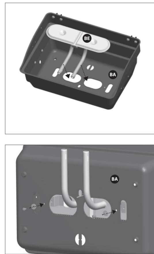
Montez le brûleur (BE) dans le boîtier (BA), en orientant les tubes venturi vers l'avant.
