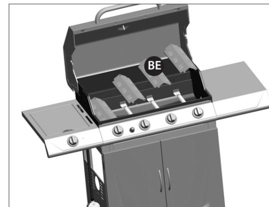
Placez les protecteurs de flamme (BE) dans l'assemblage du boîtier du brûleur (BA), tel qu'indiqué sur l'illustration.
