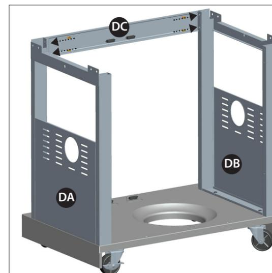
Fixez le rail supérieure (DC) à l'arrière des panneaux latéraux gauche et droit (DA et DB).
