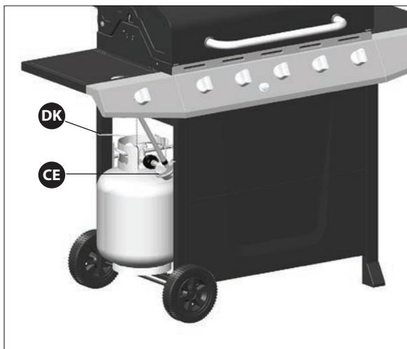
Placez le fond de la bonbonne de propane dans les encoches situées sur le bas du panneau latéral gauche du chariot (DB). Positionnez le support pour réservoir de gaz (DK) sur la collerette de la bonbonne. Attachez l'écrou de serrage du régulateur (CE) à la valve de la bonbonne de propane.
