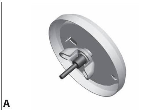
a. Retirez la quincaillerie et la collerette du thermomètre préassemblé au thermomètre (AB), tel qu'illustré aux schémas A et B.
