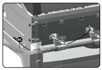
Attention: Alimentez le fil d'électrodes du brûleur principal (BC) à travers le trou sur le côté gauche de compartiment des brûleurs près de l'ensemble de tubulures.
