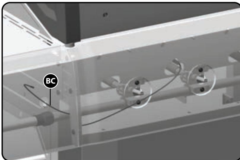
**Attention:** Alimenter le fil d'électrodes du brûleur principal (BC) à travers le trou sur le côté gauche de compartiment des brûleurs près de l'ensemble de tubulures.
