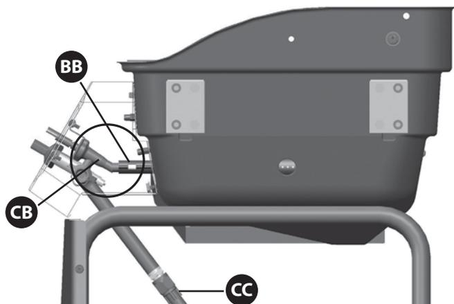
Positionnez les valves (CB) dans les tubes du brûleur (BB) avant l'assemblage.
