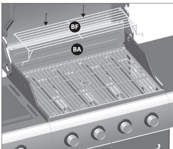
Insérez les deux petites barres de niveau de la grille de réchaud (BF) dans le panneau arrière du compartiment des brûleurs (BA).
