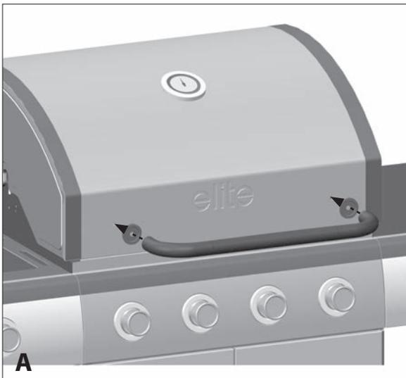
Remontez la poignée du couvercle (AB) et les nouvelles collerettes pour poignée du couvercle (AC) au couvercle supérieur (AA), en utilisant la quincaillerie mise de côté à l'étape 8.
