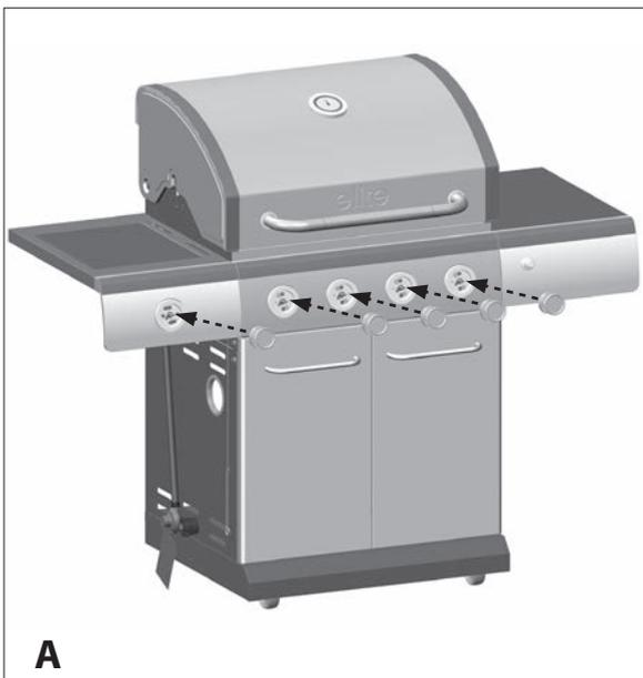
Remontez les boutons de commande (CC) retirés à l'étape 2 au panneau de commande (CH) et à la bordure de la tablette latérale (DB).
