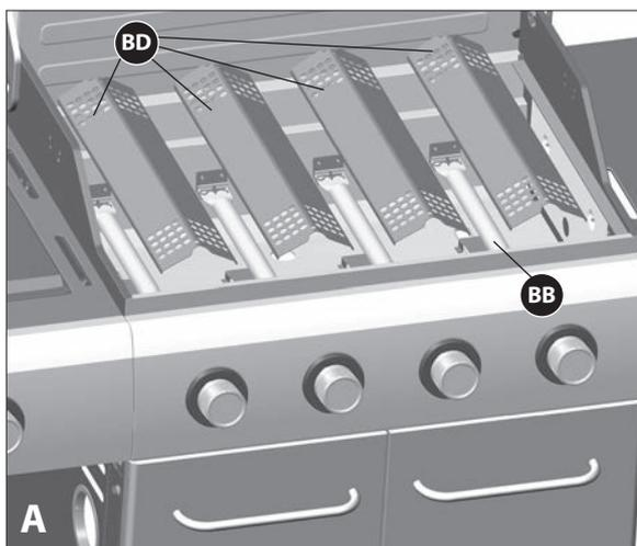
Positionnez les brise-flammes pour brûleurs principaux (BD) dans le compartiment des brûleurs (BA).
