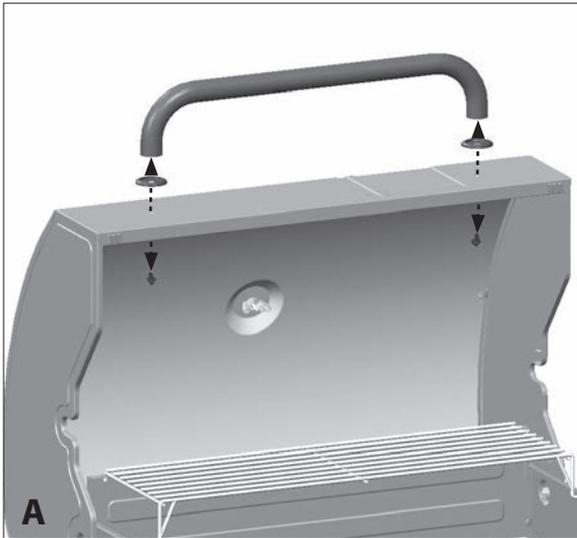
Retirez la poignée du couvercle (AB) et les collerettes pour poignée du couvercle (AC) du couvercle supérieur (AA). Mettez la quincaillerie de côté.
