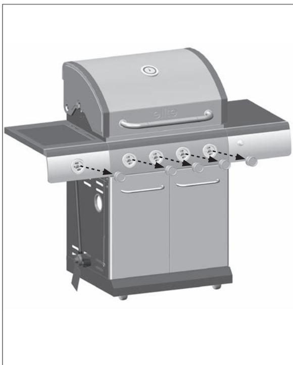
Retirez les boutons de commande (CC) du panneau de commande (CH) et de la bordure de la tablette latérale (DB).
