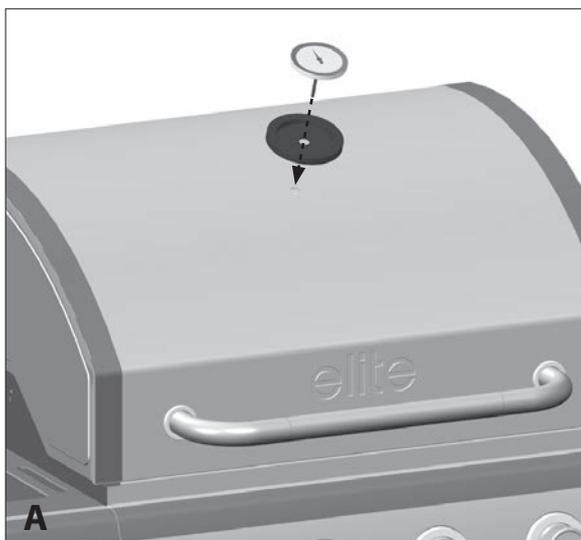
Remontez le thermomètre (AD) et la nouvelle collerette pour thermomètre (AE) au couvercle supérieur (AA) en utilisant la quincaillerie mise de côté à l'étape 6.
