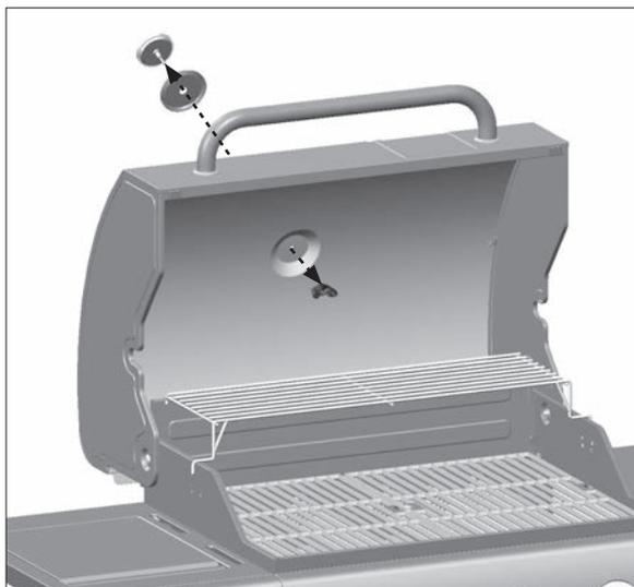
Retirez le thermomètre (AD), la collerette pour thermomètre (AE) et la quincaillerie du couvercle supérieur (AA). Mettez cette quincaillerie de côté.
