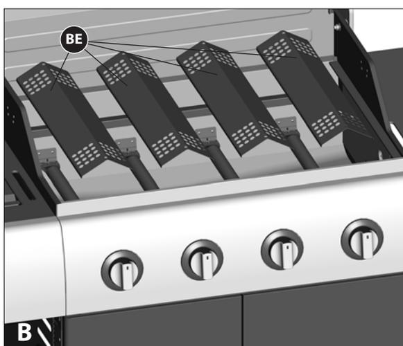
b. Positionnez les brise-flammes (BE) dans le compartiment des brûleurs (BA).
