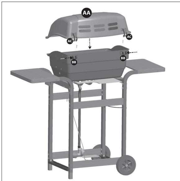
Pour monter le couvercle supérieur (AA) au boîtier du brûleur (BA), positionnez les charnières supérieures (AC) entre les charnières inférieures (BB), mettez les ferrures en place, puis verrouillez à l'aide des goupilles.
