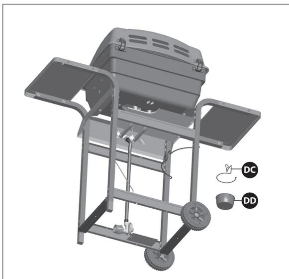
Suspendez le crochet du réservoir de graisse (DC) au bas du boîtier du brûleur (BA), tel qu'indiqué. Placez le réservoir de graisse (DD) sur le crochet (DC).
